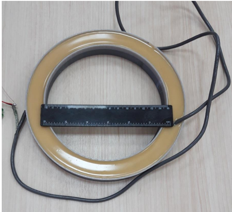
Датчик для контроля высоковольтных кабелей переменного тока с изолированной нейтралью 3-35кВ
